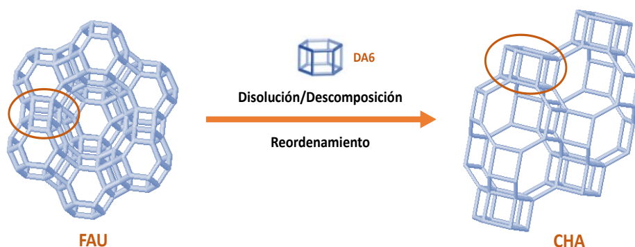
Figura 1.2.4. Esquema de la transformación de la zeolita precursora (FAU) en una nueva estructura (CHA), por disolución y reordenamiento de fragmentos estructurales comunes (DA6)
