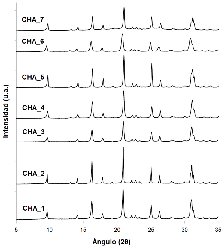
Figura 4.2.1. Difractogramas de rayos X en polvo de las muestras tipo CHA sintetizadas
