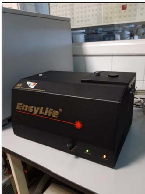
**Figura 20.** Espectrofluorímetro de tiempo resuelto EasyLife X (Optical Building Blocks)
