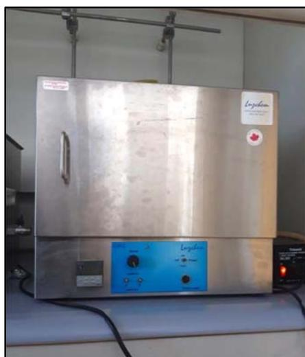
**Figura 21.** Cámara de irradiación LuzChem
