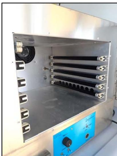
**Figura 22.** Cámara de irradiación LuzChem con 10 lámparas de  $\lambda = 355$  nm
