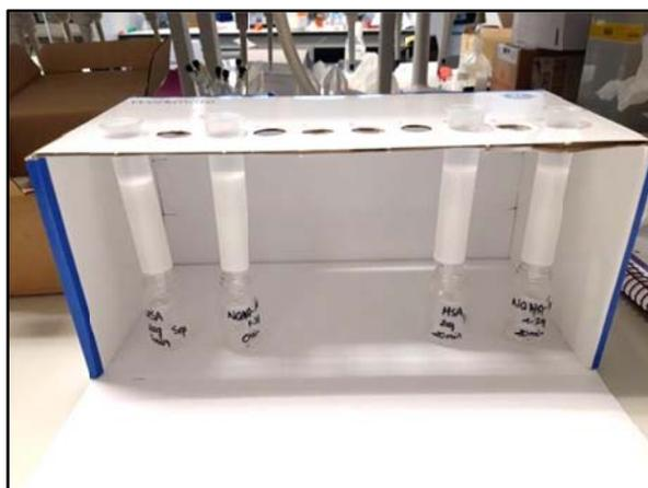
**Figura 37.** Columnas de filtración en gel Sephadex®
