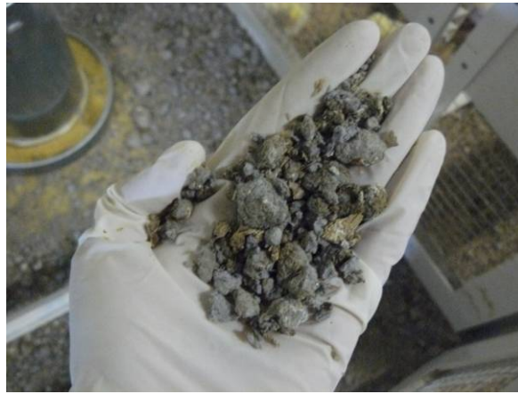
Figura 13. Lodos de destintado.
