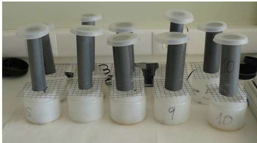
Figura 15. Imagen del análisis de la capacidad de retención de agua de las 10 muestras procesadas
