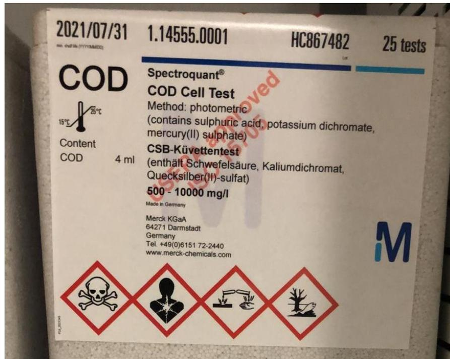
*Figura 14.* Kit spectroquant DQO rango de medición 500-10000 mg DQO·L<sup>-1</sup>
