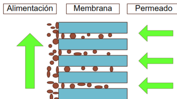
Figura 3.7 Esquema de limpieza de membranas con Contralavado [30]
