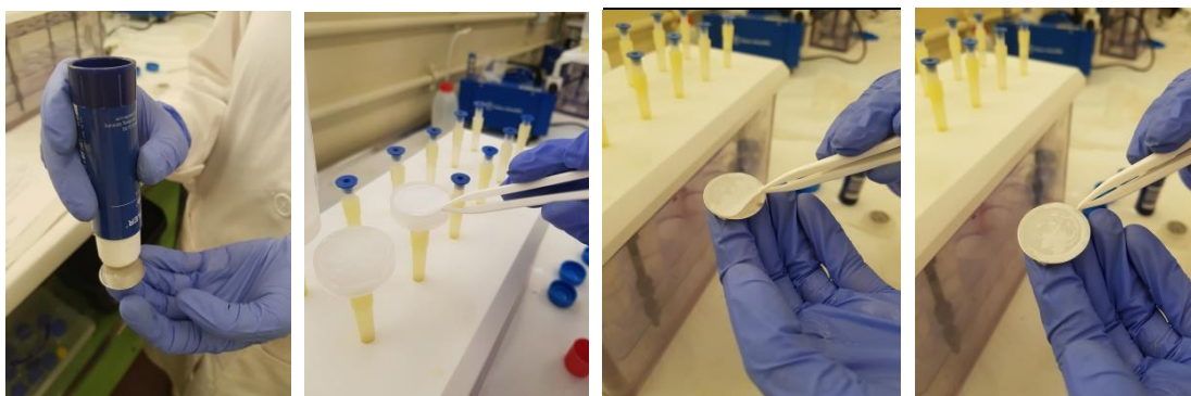
Figura 21. Proceso de desmontaje de la unidad de filtración y pegado del filtro.
