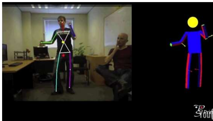
Figura 20. Esqueleto virtual generado por Kinect de [REF6]
