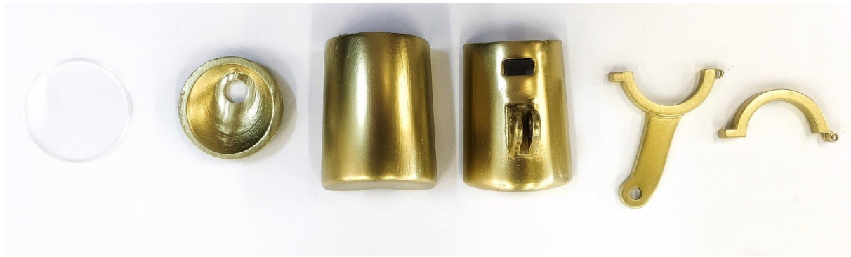
Figura 14. Piezas masilladas y pintadas.
