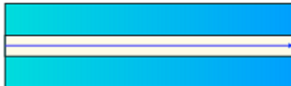
Figura 10: Propagación de los haces de luz a través de una fibra monomodo
