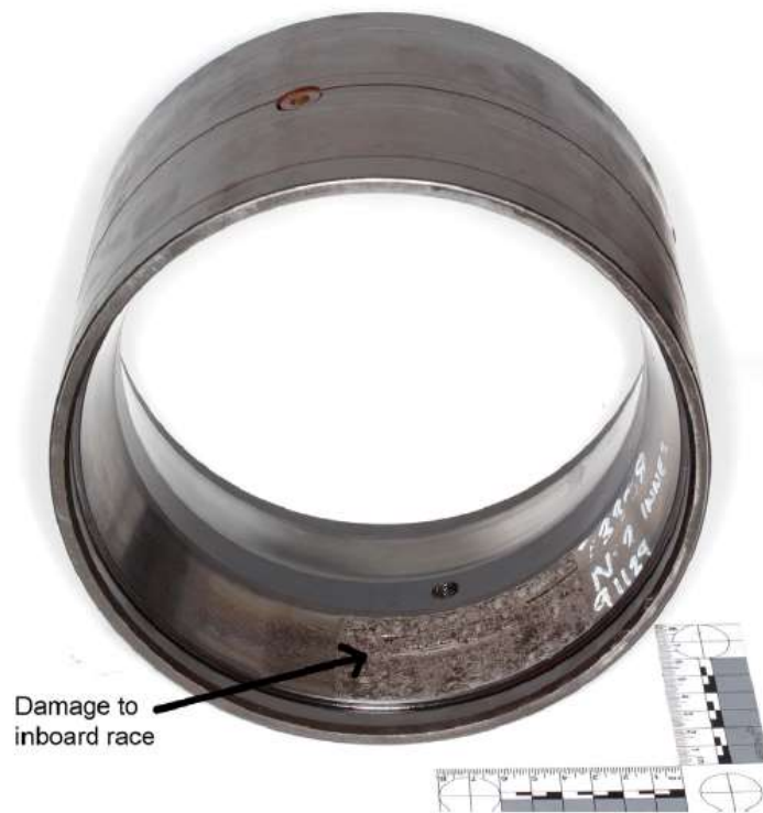
Figura 40 Daño en pista externa del rodamiento encontrado después del desmontaje del rodamiento detectado por las mediciones de vibración mostradas en la Figura 39 (Symonds et al., 2015)
