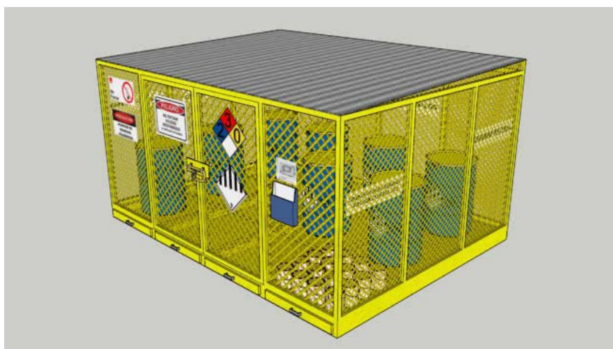
Figura 10: Jaula de Residuos Peligrosos.
