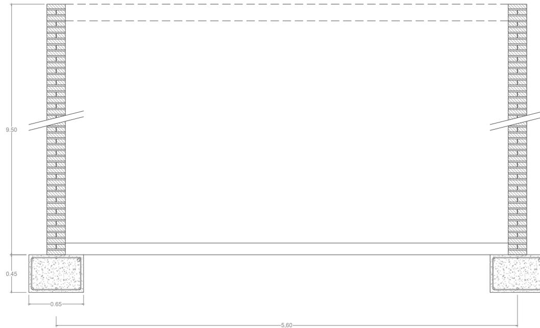
El sistema constructivo de las viviendas familiares se inspira en el prototipo de maison lilloise de 1930. Muros estructurales de ladrillo que en este caso se desplazan a la altura de la entrada para incorporar de forma más eficiente el programa y las escaleras y permitir la linealidad ya explicada. Los ladrillos quedan vistos como un gesto para incorporar la materialidad en el proyecto, así como los forjados de bovedilla catalana resultos con doble hoja de rasilla y perfiles IPE.
