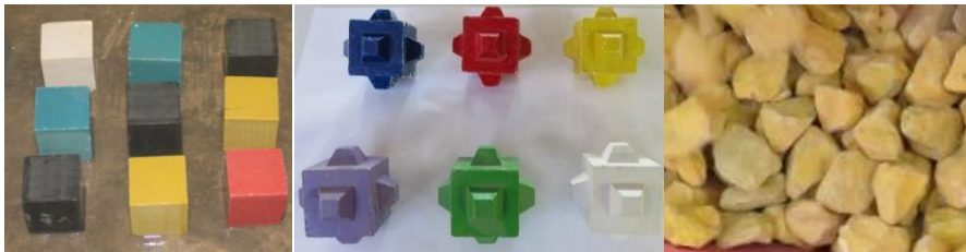
Figura 3.10. Cubos, Cubípodos y escollera utilizados en el manto principal de los ensayos.
