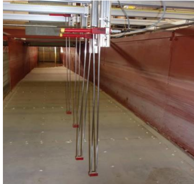
Figura 3.20. Sensores de capacidad utilizados en el LPC-UPV.
