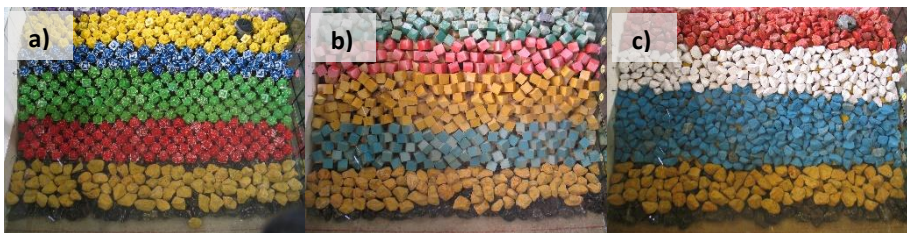
Figura 3.30. Tipologías de manto ensayadas: (a) Cubipodos monocapa, (b) cubos bicapa y (c) escollera bicapa.
