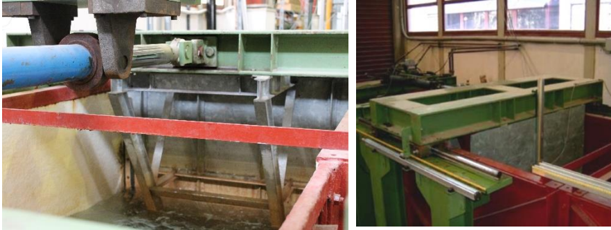
Figura 3.5. Pistón y pala generadora de oleaje del canal del LPC-UPV.
