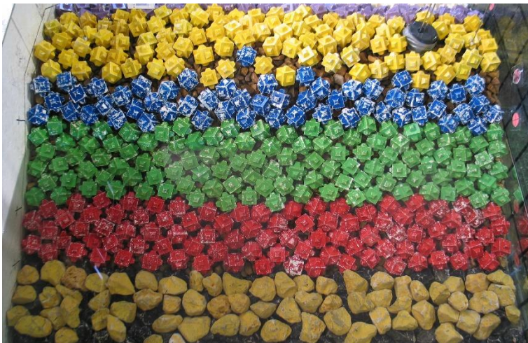
Figura 4.69. Avería del manto principal de Cubipodos monocapa en talud frontal y coronación tras un ensayo con pendiente m=1/25 .
