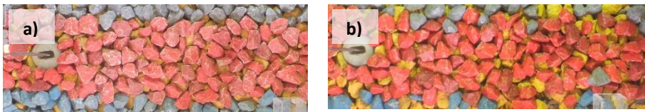
Figura 4.55. Nivel de daño cualitativo en coronación y manto bicapa de escollera: (a) Inicio de serie sin daños y (b) Inicio de avería (IA).
