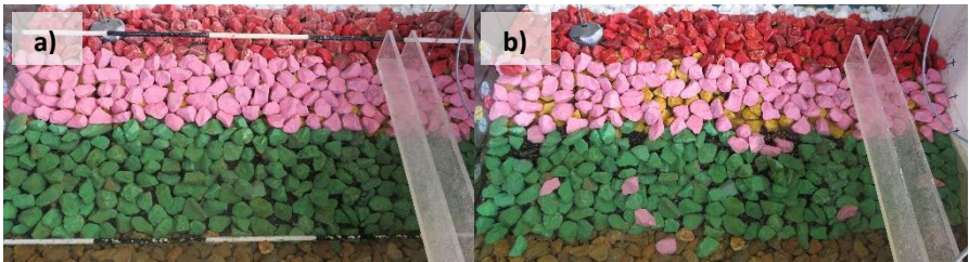
Figura 4.58. Nivel de daño cualitativo en trasdós y manto de escollera: (a) Inicio de serie sin daños y (b) Inicio de avería (IA).
