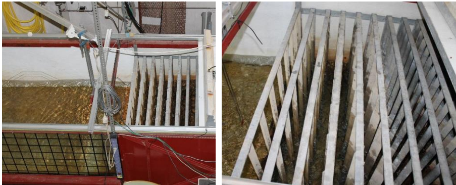
Figura 3.3. Sistema disipador de energía del oleaje del canal LPC-UPV.
