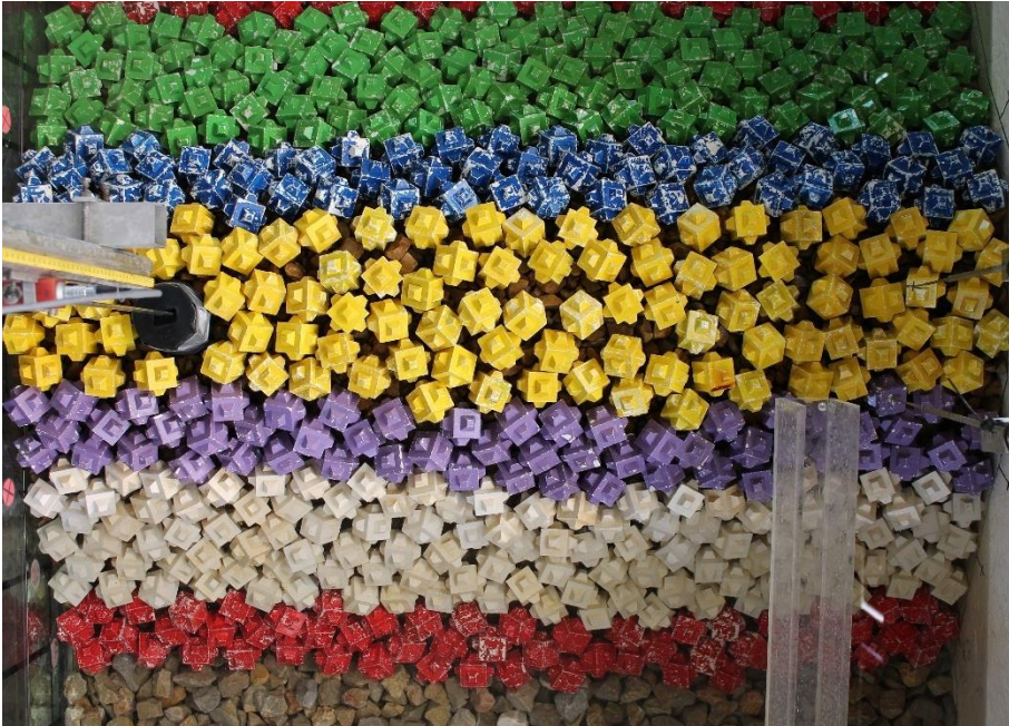
Figura 4.70. Ejemplo de Inicio de Avería (IA) en la coronación de un manto monocapa de Cubípodos.
