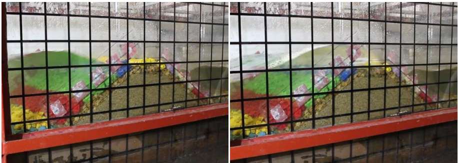
Figura 4.67. Rebase de una ola con modelo de Cubípodos monocapa y pendiente suave m=1/50 .
