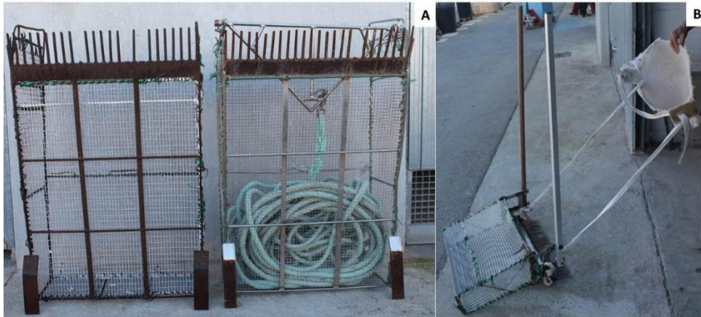
Figura 1.2: Dragas utilizadas para la pesca de C. gallina y D. trunculus , respectivamente, desde embarcación (A) y draga utilizada por los mariscadores a pie para la extracción de D. trunculus (B).
