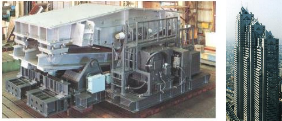
Figura 26a: amortiguador híbrido de masa sintonizado. Figura 26b: Torre Shinjuku Park. Fuente: Kareem, Kijewski, Tamura, 1999.
