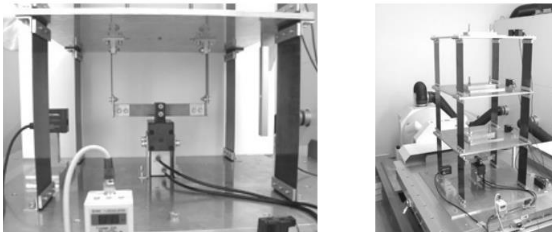
Figura 4.2: Experimento de simulación de una estructura de tres pisos, con un amortiguador localizado en el primer piso.
