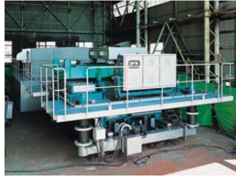
Figura 28a: concepto del sistema DUOX HMD; Figura 28b: Sistema DUOX HMD. Fuente 28a: Kareem, Kijewski, Tamura, 1999; Fuente 28b: https://www.kajima.co.jp/english/tech/seishin_menshin_e/structural/index.html
