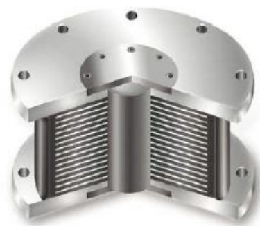
Figura 49: aislador sísmico de capas de goma y acero, con núcleo de plomo. Fuente: Genatios, Lafuente, 2016.
