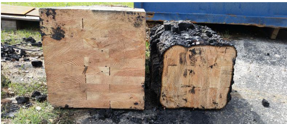
Fig.40: madera intacta detrás de la madera carbonizada, Arup
