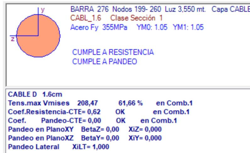
*Cable que atirante los forjados de la planta primera*
