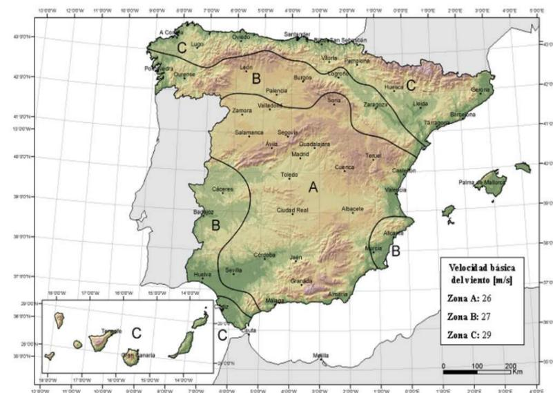
Siendo  $q_b$  la presión dinámica del viento. El valor se obtiene a través del *mapa D1 del Anejo D* y para el caso de Valencia (zona A) resulta ser  $q_b = 0,42 \text{ kN/m}^2$ .
