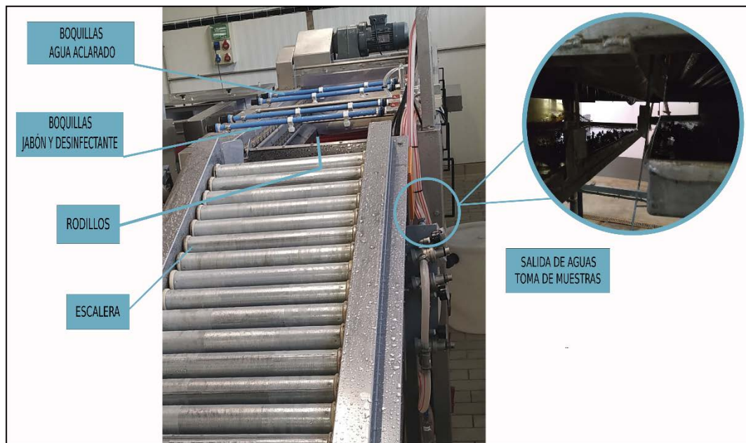
Figura 5. Imagen de una lavadora industrial de cítricos a pequeña escala para realización de ensayos con identificación de las partes principales que la componen y localización de la toma de muestra.
