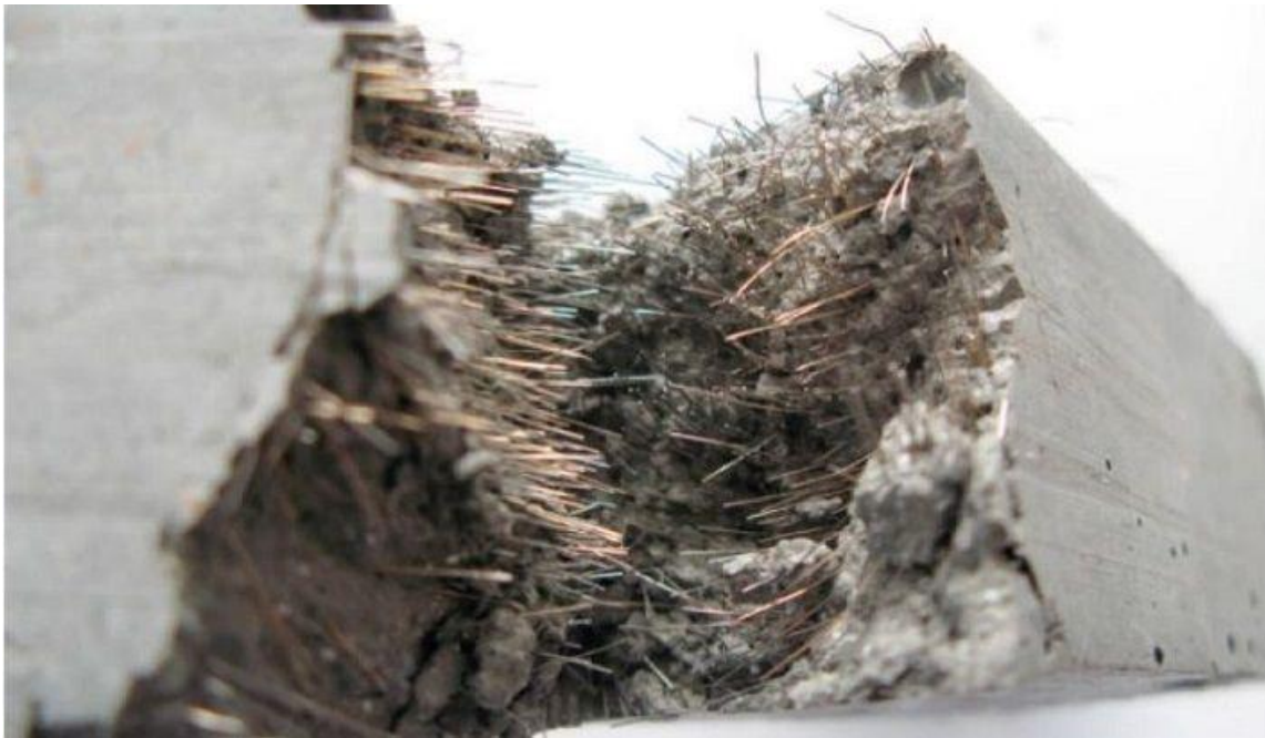
Figura 4. Detalle de las fibras de un hormigón de alta resistencia. Fuente: https://bit.ly/2ZdMBYB
