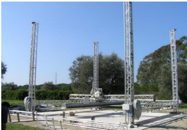
Figuras 37 y 38. Máquina de impresión y detalle de los inyectores. Fuente: http://cort.as/-MARz
