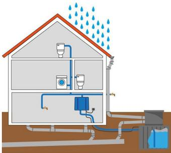
Figura 19. Sistema de recolección de aguas pluviales.
