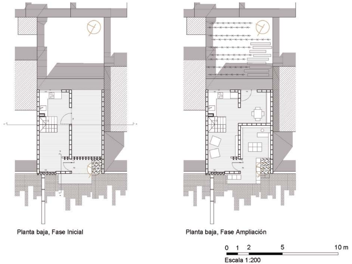
Fig. 16: Distribución propuesta DS49 autoconstrucción asistida en su fase de ampliación. Elaboración propia.
