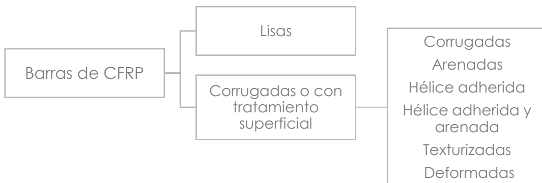
Fig. 2.19. Esquema barras de CFRP según geometría superficial.
