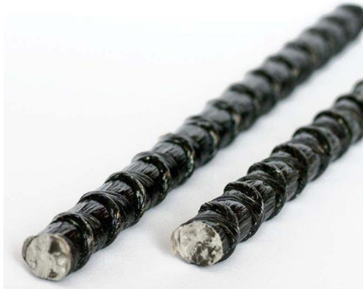
Fig. 1.12. Barras reforzadas con fibra de basalto.
