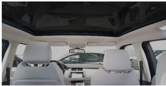
Figura 72: Interior del vehículo, techo solar Estado opaco.
