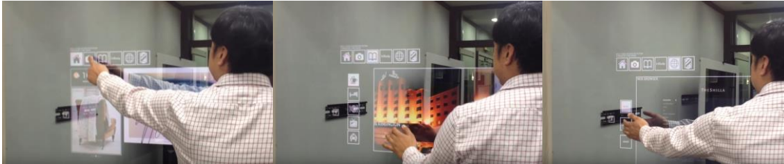
Figura 21: Prueba de uso de panel PDLC con lámina táctil sobre vidrio retroproyectado.
