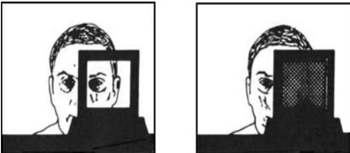
Figura 12: Ejemplo de malla polimérica con cristales líquidos dispersos en estado transparente y estado opaco.
