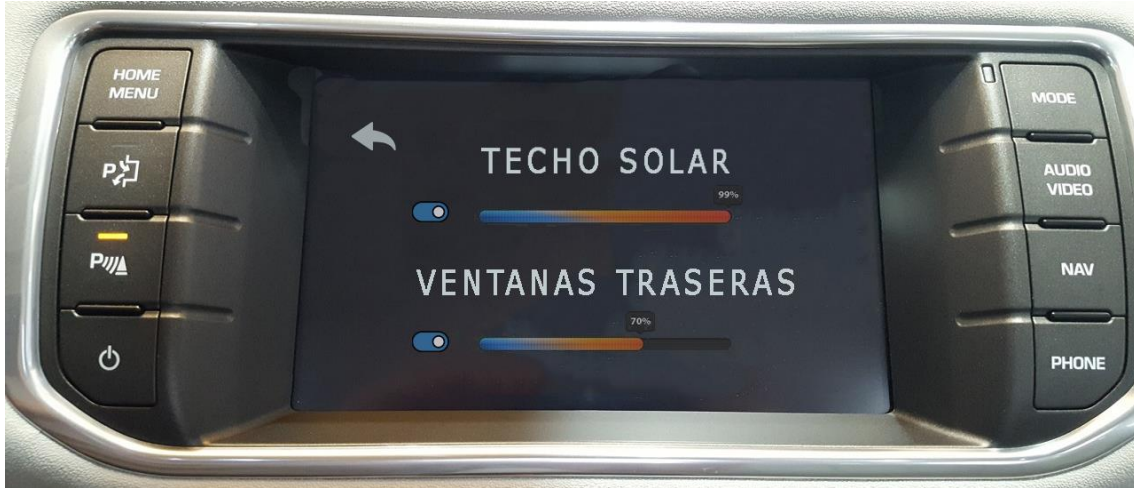
Figura 70: Propuesta de control del panel PDLC a través de la pantalla táctil del vehículo.
