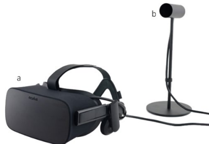
Figura 22. Sistema Oculus Rift CV1 formado por a) el casco de visualización y por el b) módulo de seguimiento Constellation.
