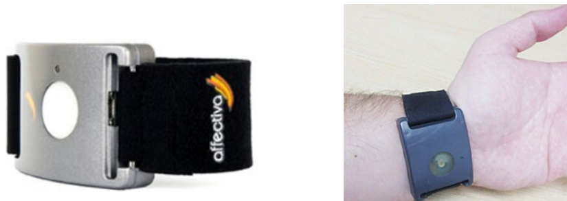
Figura 32. Dispositivo portátil utilizado para medir la actividad electrodérmica Q Sensor.
