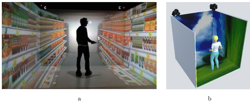
Figura 3. Sistema CAVE. Montaje experimental del sistema CAVE donde se observan a) unas gafas 3D, b) el dispositivo de interacción y c) las cámaras de seguimiento infrarrojas.
