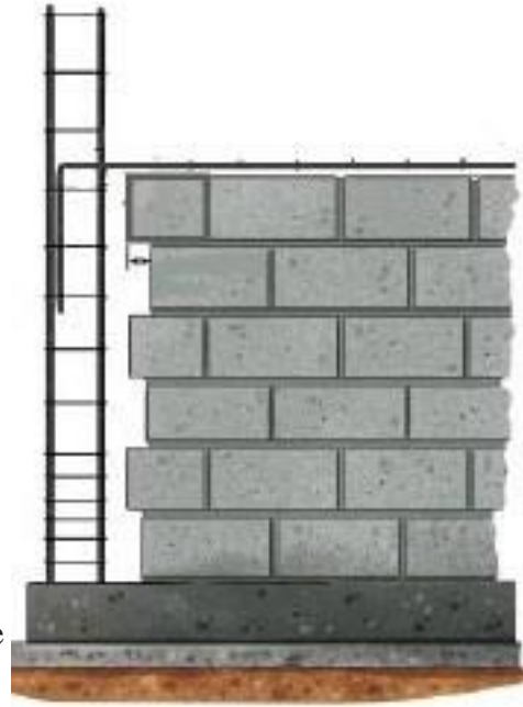
Figura 28 Vista de muro trabado con bloques de hormigón unidos por mortero de pega. Fuente:Manuel y Maria presentan "construir mejor con mamposteria confinada"
