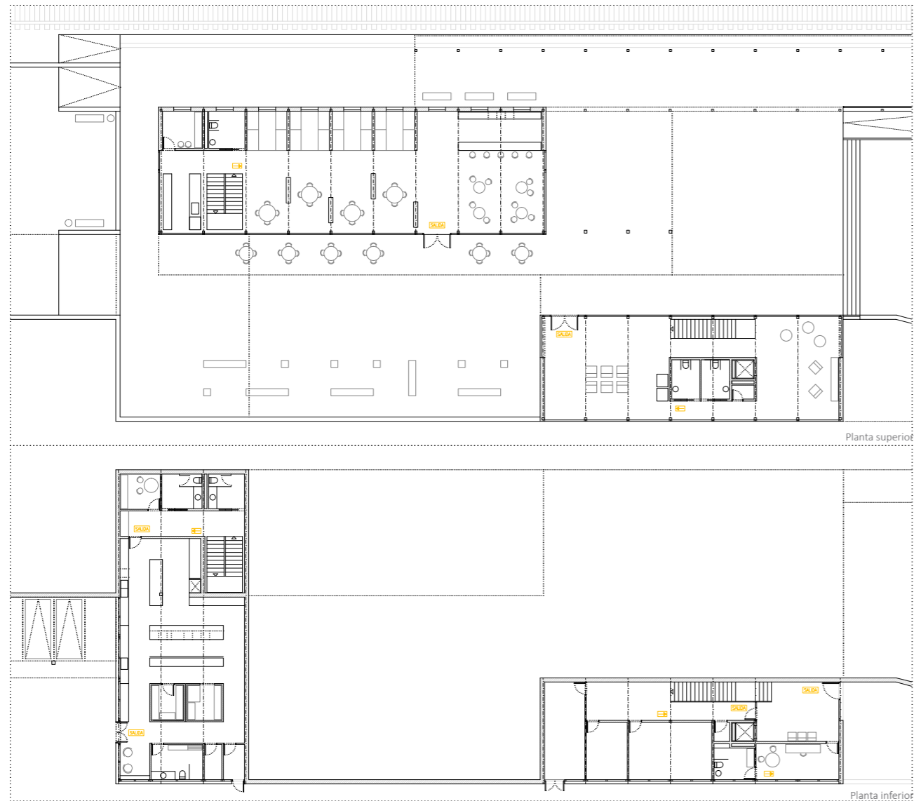
Señalización de los medios de evacuación
