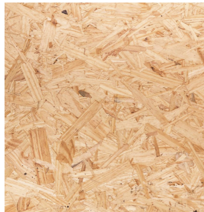
Acabado tablero OSB
