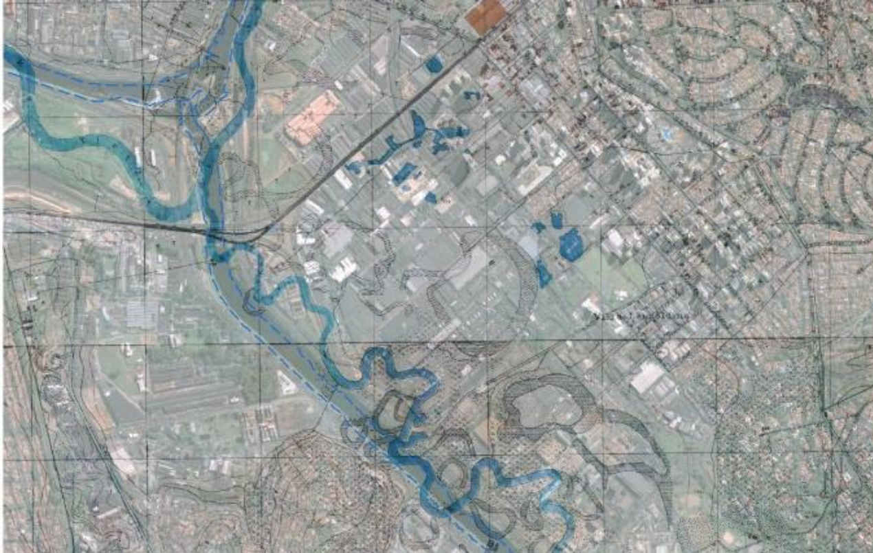
Ilustración 37 – Sobreposición de mapa topográfico de 1930 con imagen de satélite de 2015 para análisis de las transformaciones de las orillas de los ríos Tiete y Pinheiros a lo largo del tiempo. (Fuente: Dutenkefer, E. "Mapa topográfico do Sara Brasil (1930) sobreposto às imagens atuais de satélite do Google Earth". GEOUSP – Espaço e Tempo, São Paulo, v. 19, n. 1, p. 156 - 159, 2015. http://www.revistas.usp.br/geousp/article/view/97395 )
