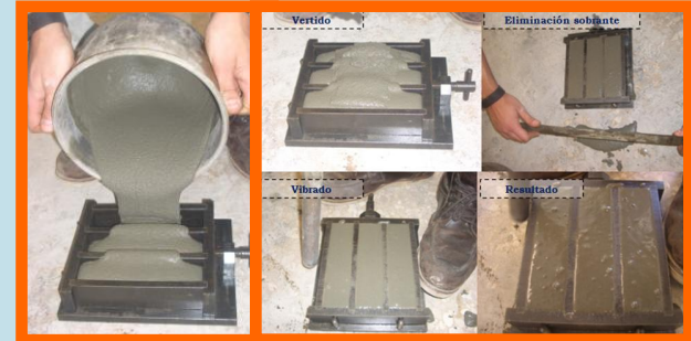
Vertido y vibrado
