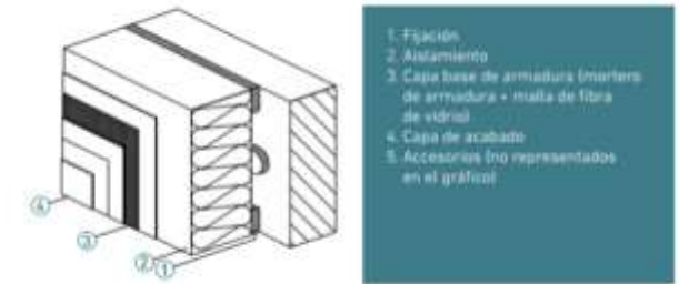
Ilustración 21: Sistema SATE
