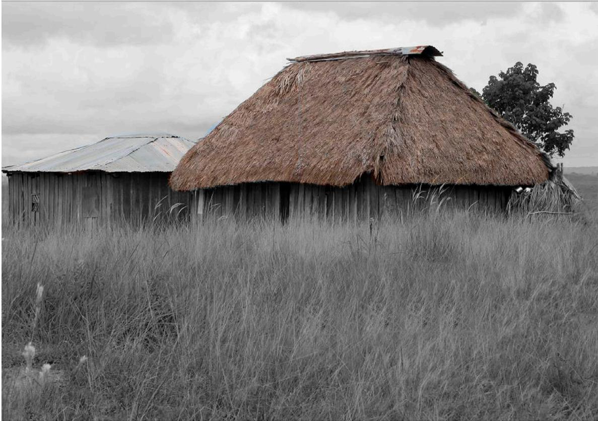
Figura 74: Viviendas nasa con cubiertas en diferentes materiales, Vivienda con teja de zinc / Vivienda con cubierta de paja
