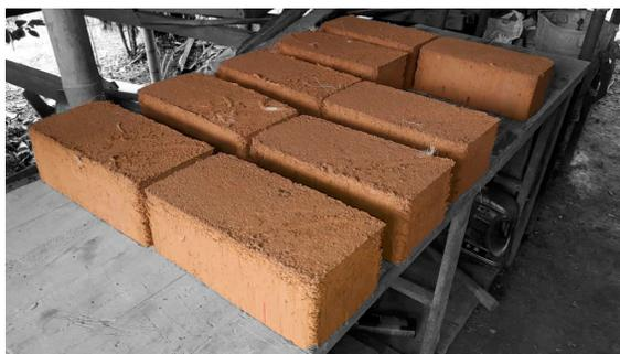
Figura 71: Bloques de Btc como nuevo material para los muros.
