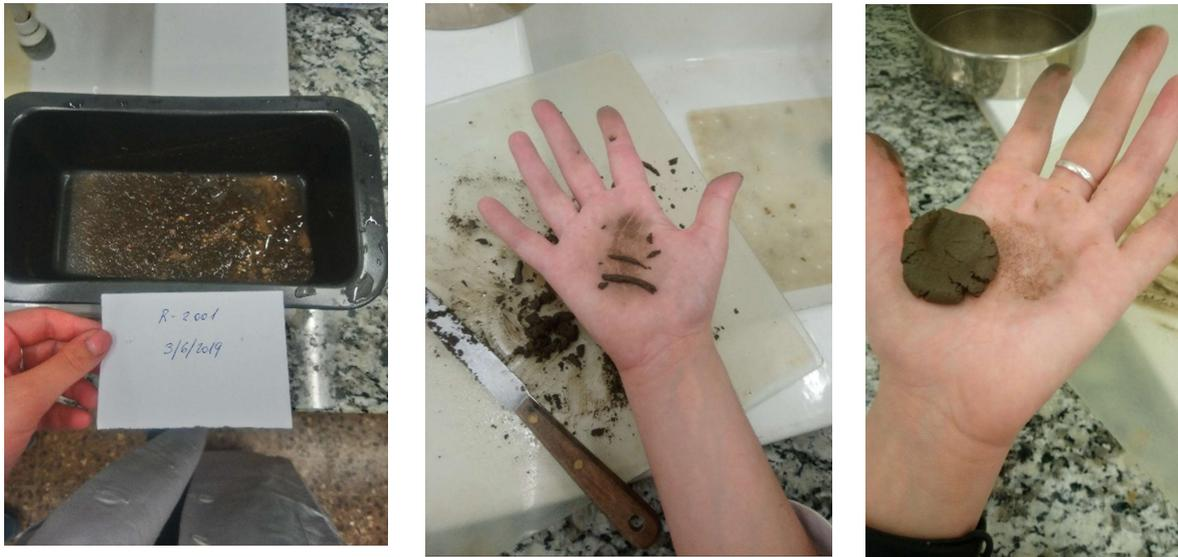
Figura 35: Ensayo de plasticidad en los rellenos analizados en laboratorio. Elaboración propia.
