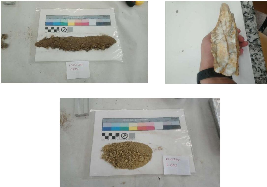
Figura 34: Diferentes clases de rellenos, relleno tomado en el talud 2 entre las juntas (izq. y abajo) y relleno de calcita en el interior de una de las muestras del talud 2 (dch). Elaboración propia.
