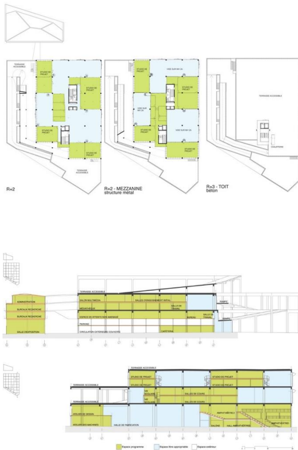
Fig. 131. Planimetría de plantas y secciones según las áreas de programa y las zonas de no programa, ENSAN.
