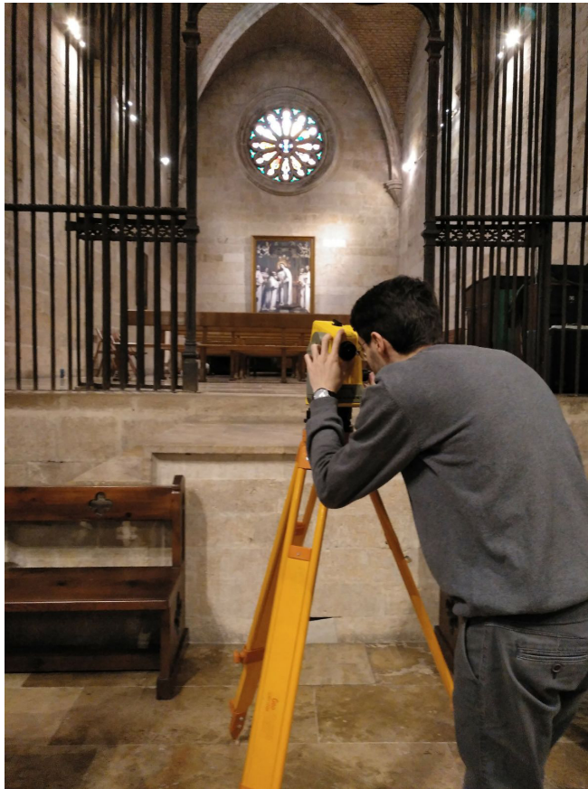
Fig.164. Javier Magán tomando puntos en la estación total. [Imagen propia, 4/4/18]
