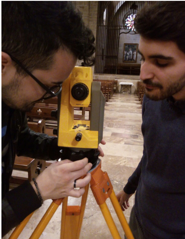
Fig.167. Nivelación de la cabeza de la estación total. Javier Magán junto a Saúl, becario de colaboración. [Imagen propia, 2018]
