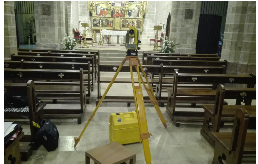
Fig.169. Instalación de la estación total en la nave central de la iglesia. [Imagen propia, 2017]
