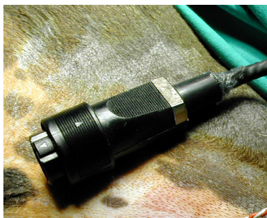
Figura 5.3. Conector al que se exteriorizan los cables eléctricos unidos a los electrodos
