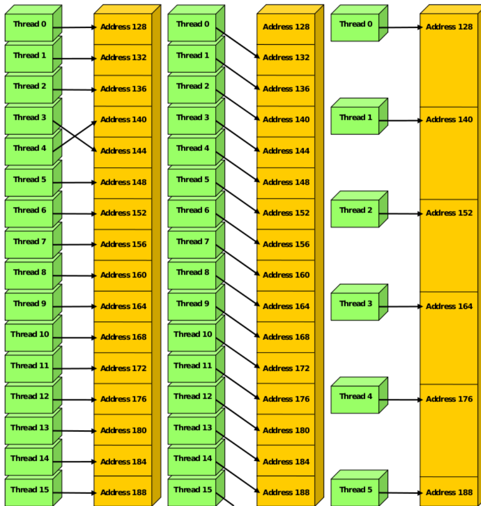
Figura 9: Ejemplos de accesos uncoalesced a memoria global.
