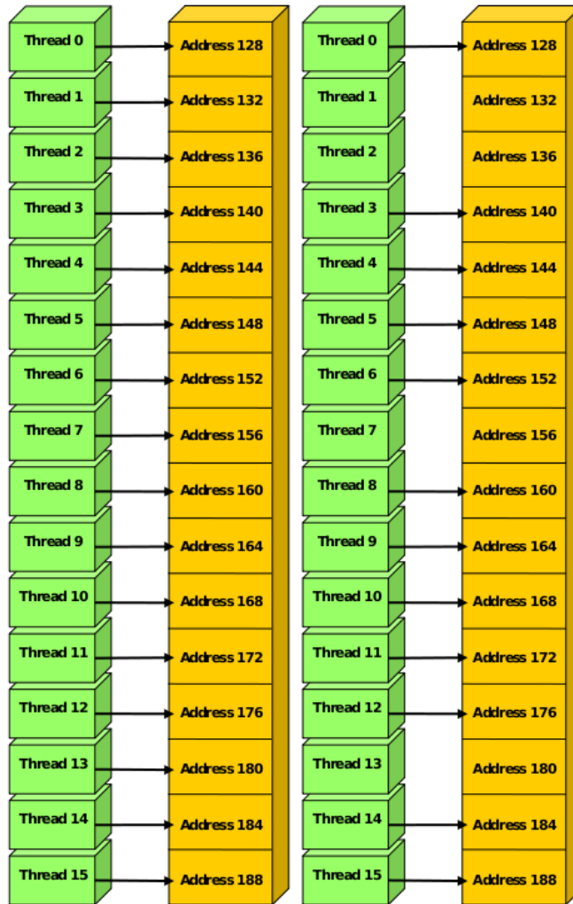
Figura 8: Ejemplos de accesos coalesced a memoria global.
