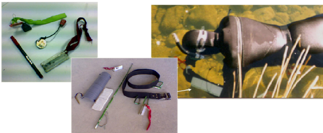
Figura 2. Equipos (marcadores, pizarra acuática, varilla) y buceador durante un trabajo de muestreo de campo mediante buceo con gafas y tubo, o snorkelling.
