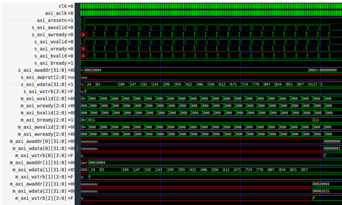
Figura 5.2: Funcionamiento del AXI Crossbar en la simulación del módulo jammer
