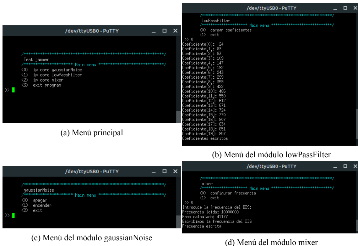
Figura 5.12: Programa para el control del módulo jammer a través del microprocesador
