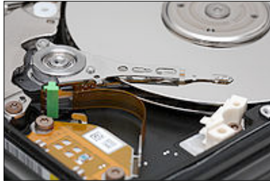
Figura 1. Detalle de un disco duro con su cabezal de lectura/escritura
