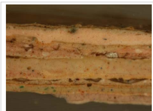
Ilustración 7: Sección estratigráfica de la policromía de la nuca de Don Liborio. Fotografía tomada con lupa binocular a 200x.
