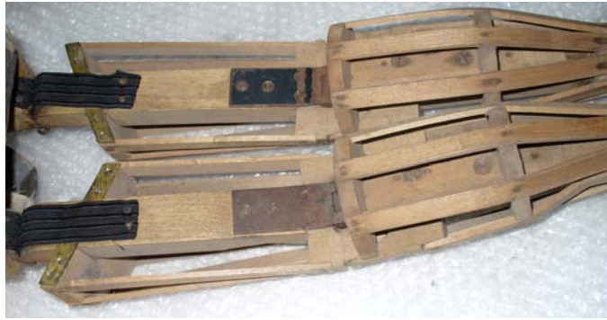
Pepito 20: estructura y articulaciones traseras de las piernas.
