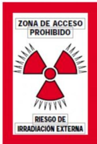
**Figura 38: Trébol de advertencia para protección radiológica de zonas controladas de acceso restringido.**
