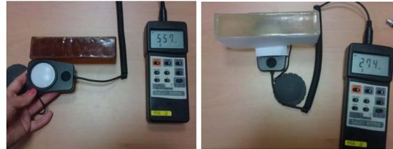
Imagen 3: Realización del ensayo de transmitancia lumínica
