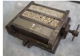
Imagen 1: Probeta con árido silíceo y resina Sikadur-52
