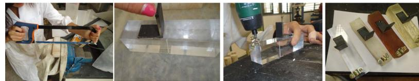
Imagen 4: Proceso de preparación de las probetas para poder medir la apertura de fisura
