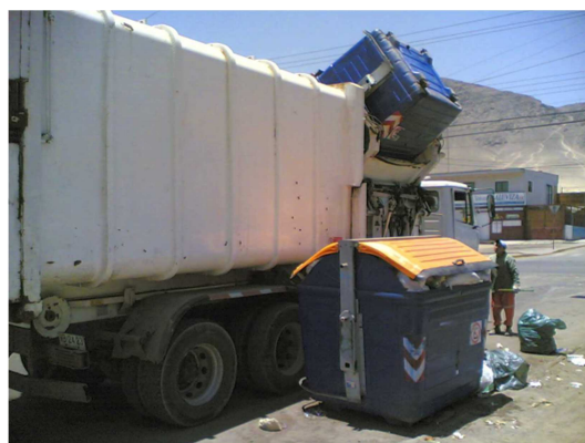
Camión de recogida selectiva de carga lateral.
