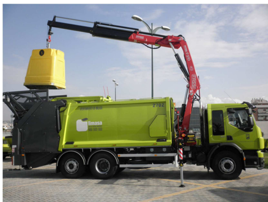
Camión de recogida selectiva con grúa.
