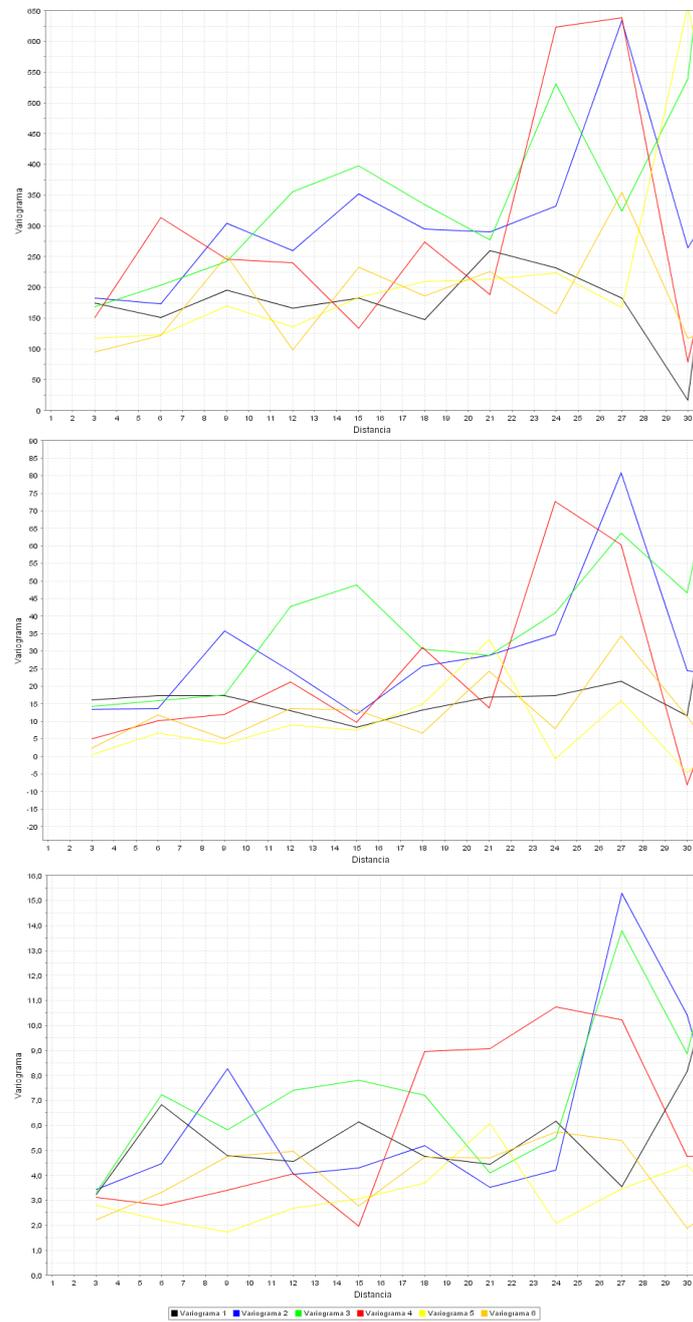
**Figura 8.5.** Variogramas direccionales de la permeabilidad (arriba), la porosidad (abajo) y cruzado (centro) para diferentes direcciones.
