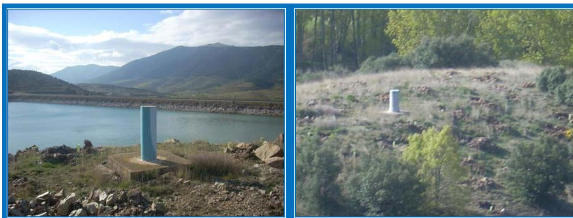
Fotografía 22: Pilares para campañas de nivelación (aguas arriba y aguas abajo).
