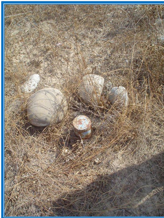
Fotografía 17: Piezómetro abierto.
