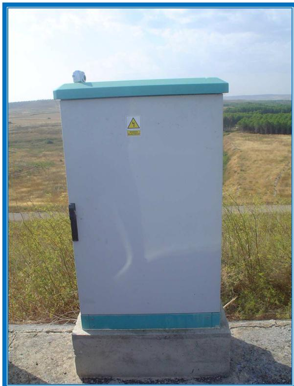
Fotografía 13: Armario de centralización de lecturas de piezómetros de cuerda vibrante.
