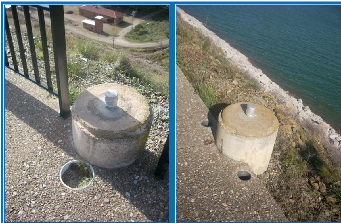
Fotografía 21: Bases para campañas de colimación (aguas abajo y aguas arriba) y clavos de nivelación.
