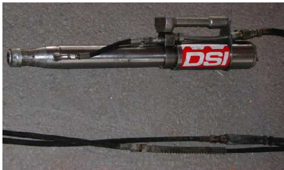
Imagen de gato hidráulico utilizado para el tesado.
