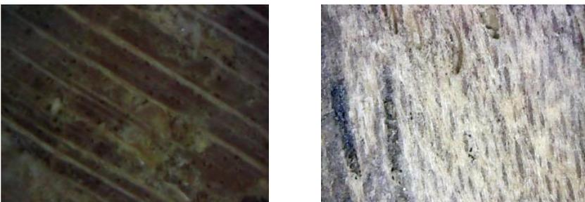
Fig. 177 y fig. 178: Sección transversal y sección longitudinal de nogal.
