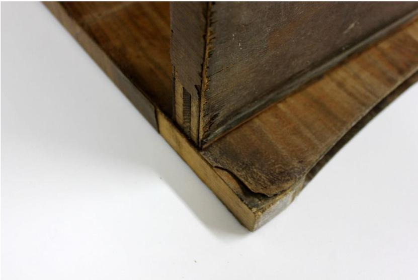
Fig. 204: Levantamiento y faltante de chapa en el *Mueble Auxiliar*.
