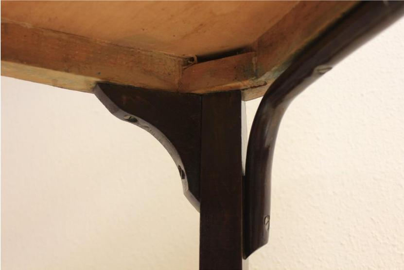
Fig. 130: Unión de la pata trasera por medio de ensamblajes de la *Pareja de sillas 1*.
