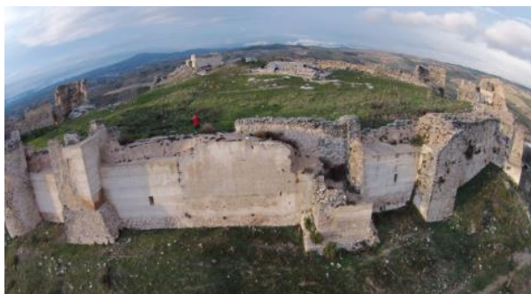
Figura 7: Imagen con importantes deformaciones radiales provocadas por la lente de la cámara FC200-Phanton2 visión-plus. FOV 110°.
