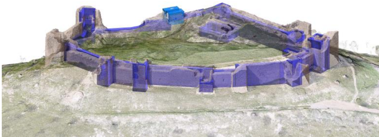
Figura 25: Modelado paramétrico de las estructuras correspondientes a la fase I en base a la inserción (vinculo) de la nube de puntos georreferenciada.
