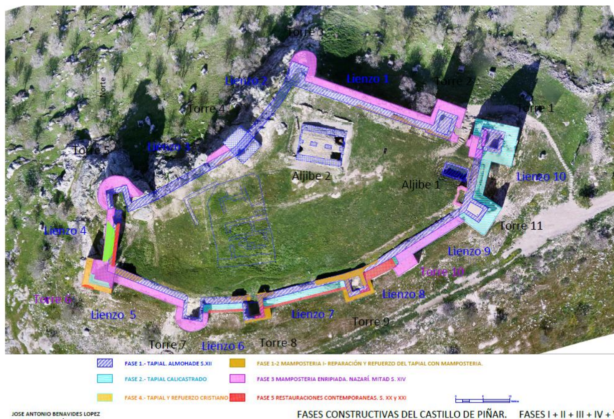
Figura 21: Representación de todas las fases constructivas sobre la ortofotografía de planta. En el interior se muestran las estructuras de las viviendas actualmente enterradas.
