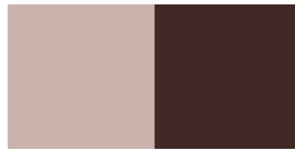
NCS S 2010-Y90R NCS S 8010-Y90R Ejemplo 2. Contraste de luminancia. Dos colores con el mismo tono y cromaticidad, pero con diferente negrura.
