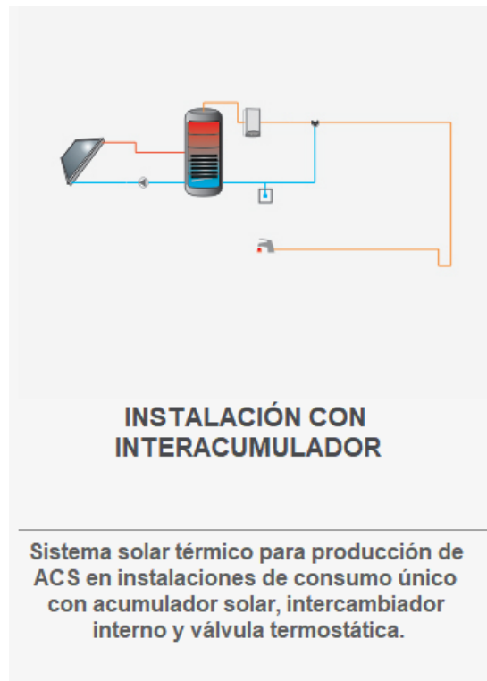
Figura 53 Instalación con Interacumulador
