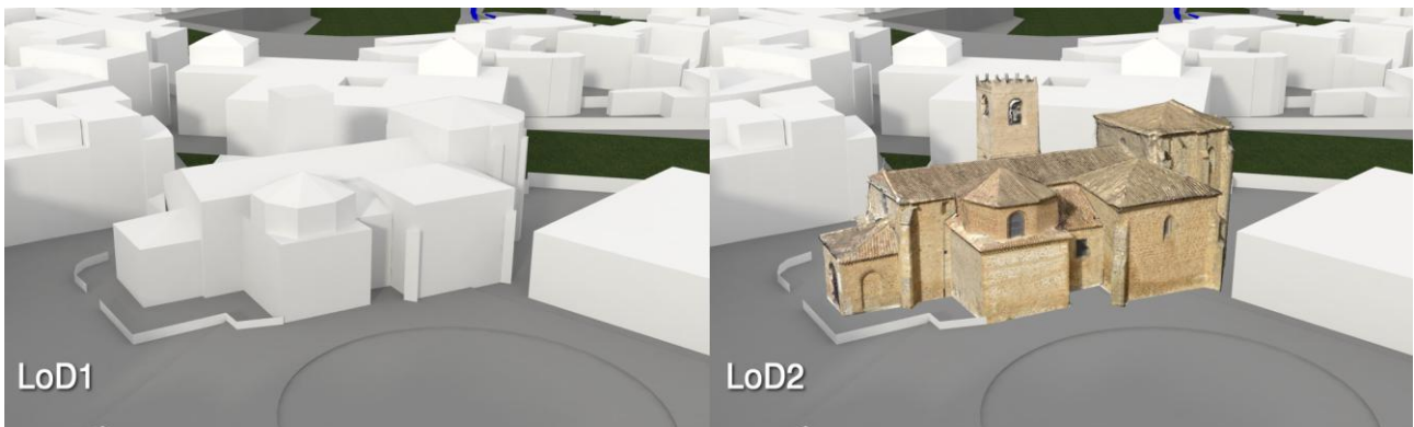
Figura 2: Diferentes tipos de detalle en vista aérea de la iglesia de San Miguel. LoD1 mediante volumetrías prismáticas y alguna alusión a las cubiertas y el Lod2 realizado mediante fotogrametría y simplificado del exterior para alta resolución.
