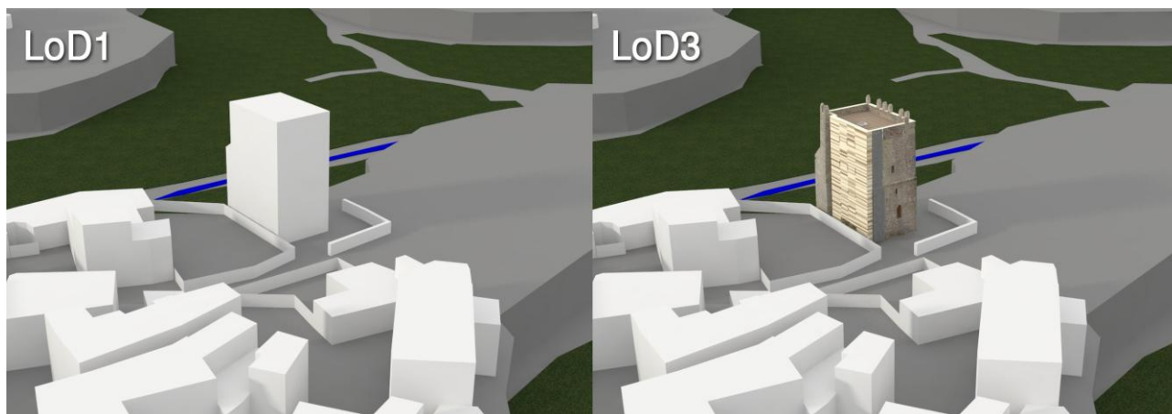
Figura 3. Diferentes tipos de detalle en vista aérea del Torreón de la Muela. LoD1 mediante volúmenes prismáticos y alguna alusión a las cubiertas y el LoD3 realizado a partir del proyecto de rehabilitación y del levantamiento topográfico detallado el exterior y el interior para alta resolución.
